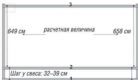
– После установки брусков 1, 2 и 3 на плоскости, измерить расстояние по верхним граням брусков 2 и 3 строго по крайним брускам контробрешетки прямоугольного ската (длинные стрелки).
